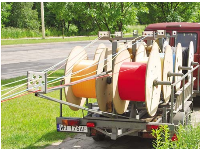
Fot. 6 Bateria siedmiu bębnow mikrorur Novomicro 7
