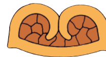
Sufficient gap between legs and bottom of crimp skrzydełka w wystarczającej odległości od podstawy
