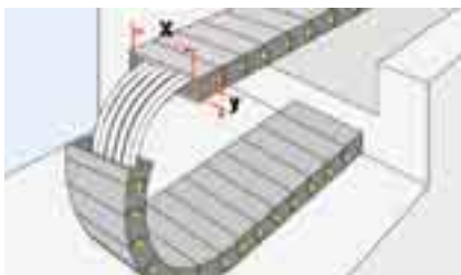
Wymiary prowadnicy łańcuchowej w relacji do wymiarów kabli / przewodów giętkkich.
